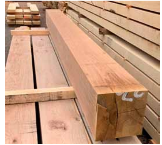
Vervolgens zijn er balken (staanders) van gezaagd van 30 bij 30 cm, voor constructie.
