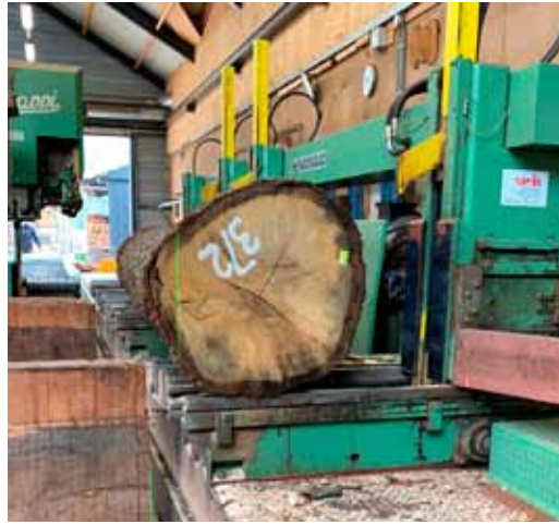
De stam wordt eerst doorgekort op 4 meter.
