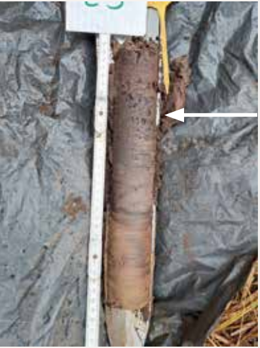
Figuur 15: De Entenschlatt bij Burlo op de Topografische Militaire Kaart van 1852 (bron: beeldbank VU). Links een dijkje in het complex, waaronder het intacte bodemprofiel is gestoken en bemonsterd. Het dijkje heeft het onderliggende veenpakket beschermd tegen verdroging en mineralisatie van veen. De koolstofdatering van het veen (witte pijl) op het zandpakket komt uit de periode tussen 1525-1660. Vermoedelijk is het bovenliggende veenpakket ontstaan na de aanleg van de jachtplaats. Foto's: A.A.M. Kieskamp.
