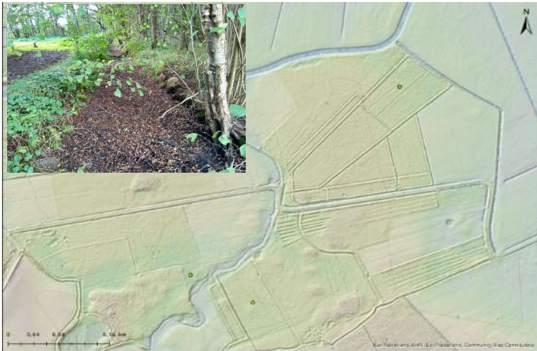
Figuur 4-19: Het inzetkaartje (AHN4) toont de oudere ontwatering op landgoed Rheebruggen vanuit het zuiden. Door de moderne, diepere ontwatering in het noorden is het oude watersysteem (foto) droog komen te liggen en is de omgeving sterk verdroogd en verzuurd.
