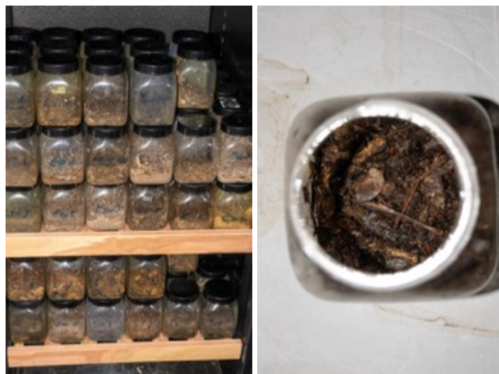
Afb. 2.2 Opzet van het miljoenpoten experiment. Ieder individu werd in een plastic pot met verzameld verterend strooisel met wisselende hoeveelheden en type steenmeel gebracht (foto rechts). Potten werden met deksels afgesloten maar niet volledig dichtgedraaid om gasuitwisseling tussen controlemomenten met de buitenlucht mogelijk te maken. Alle potten werden in een koelinstallatie bewaard bij een constante temperatuur van 15 graden Celsius en continu hoge RH (foto links).
