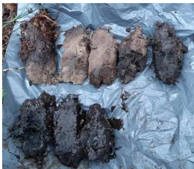
Figuur 43. Bodemprofiel uit boring van Motketel 1. Verspoelt zand op een veenlaag.
