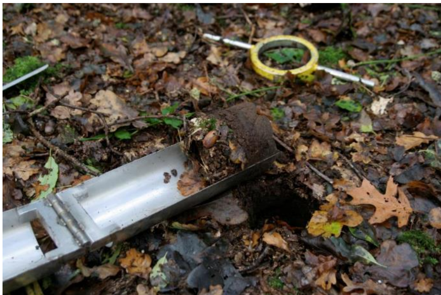
Figuur 9. Opengeklapte steekbuis met monster voor analyse van de mesofaunasamenstelling.
