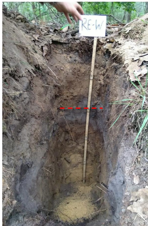
Foto 3: Voorbeeld profielkuil bij Renkum (holtpodzolgrond). Met de rode stippellijn is de overgang van het wallichaam en de fossiele bodem aangegeven.
